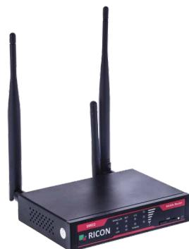
**RICON S9922M2E-LTE Router**, Ricon Mobile Inc. tarafından endüstriyel sınıf kalitesinde LTE hücresel ağ teknolojisine uygun olarak tasarlanmış ve üretilmiştir. Gömülü hücresel modülü ile, ATM bağlantısı, uzak ofis güvenlik bağlantısı, veri toplama vb. gibi birçok durumda yaygın olarak kullanılır.
